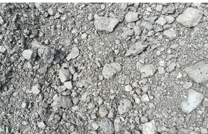
Nahaufnahme des EOS-Granulats (Foto: Stahlwerk Gerlafingen)
